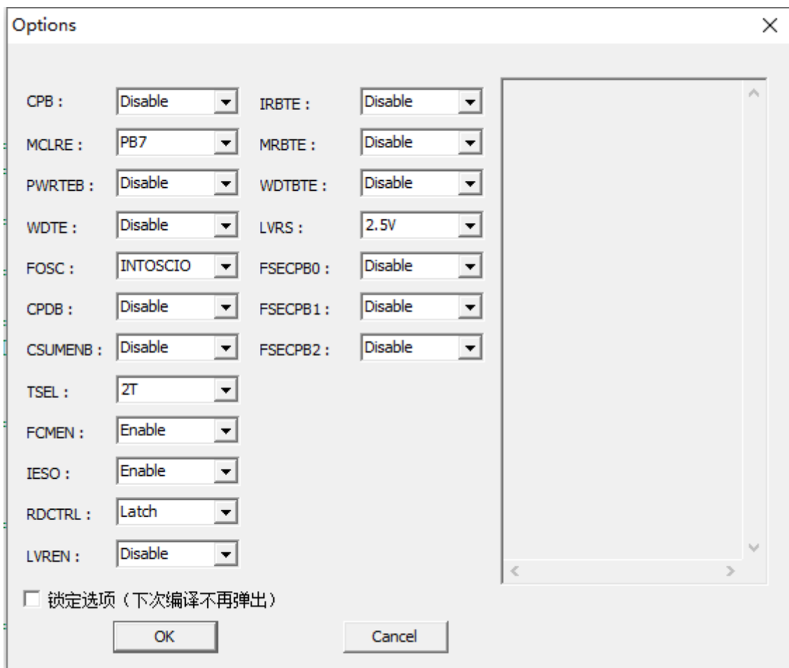
图 16-1 由 IDE 设置的初始化配置寄存器
