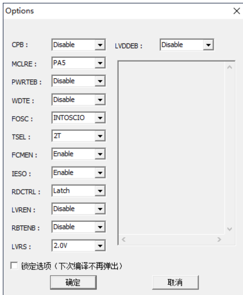
图 14-1 由 IDE 设置的初始化配置寄存器
